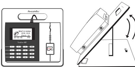
FingerTec menawarkan flexi-kit untuk semua model pencatat waktu kehadirannya. Pasangkan terminal pada flexi-kit untuk tujuan kenyamanan
