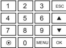
Anda dapat memasukkan input ke terminal-terminal melalui papan tombol. Papan ini mengandung angka dari 0-9, tombol daya on/off, sebuah tombol OK, sebuah tombol ESC/Batal, sebuah tombol Scroll (gulung) ke atas/bawah, sebuah tombol bel pintu dan sebuah tombol Menu.
