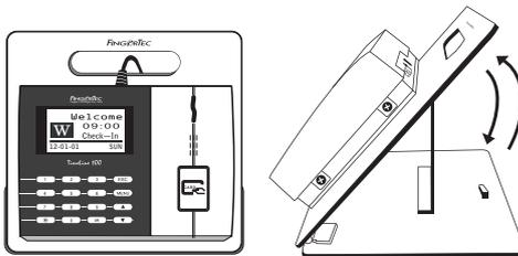
FingerTec為它的所有考勤機型提供Flexi-kit。將終端機置放在Flexi-kit，使用方便。
