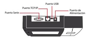
El enchufe de alimentación se coloca en la parte superior del terminal, con la etiqueta de Puerto de Adaptador de Corriente como indicado en el siguiente diagrama.
