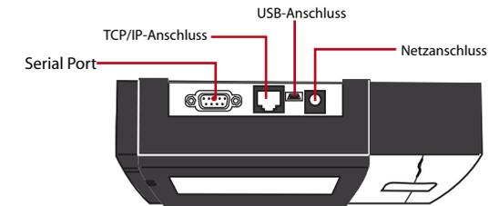
Bitte benutzen Sie den bereitgestellten Stromadapter oder alternativ einen Gleichstromadapter mit den Spezifikationen 5VDC 2A. Stecken Sie ein Ende des Stromadapters in das Terminal und das andere Ende in die Steckdose. Überschreiten Sie nicht die empfohlene Stromspannung oder Stromstärke um Schäden am Gerät zu vermeiden.
