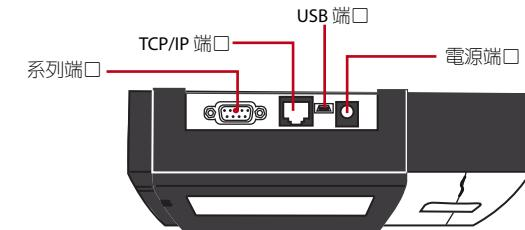
電源插口位於終端機的頂部，在下圖中標記為「電源適配器端口」。
