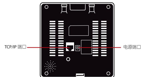
电源和通讯连接点位于终端机的背面。
