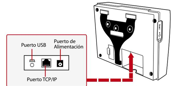
Favor de utilizar el adaptador de potencia suministrado en el paquete o, alternativamente, se puede optar por una fuente de alimentación lineal con especificaciones de 5VDC 2A. Enchufe un punto del adaptador de potencia al terminal y el otro extremo a la toma de corriente. No exceda el voltaje o la corriente recomendada para evitar dañar el terminal
