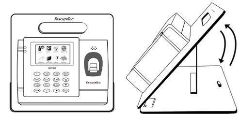
FingerTec ofrece los flexi-kit para todos sus modelos para control de asistencia. Conecte el terminal a un flexi-kit para mayor comodidad.
