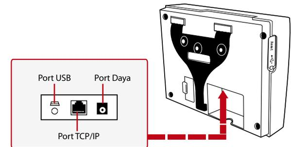
Gunakan adaptor listrik yang disertakan dalam kemasan atau Anda dapat menggunakan catu daya linier dengan spesifikasi 5VDC 2A. Colokkan satu ujung adaptor listrik ke terminal dan ujung lainnya ke stok kontak. Ikuti saran arus dan tegangan listriknya agar tidak merusak terminal.
